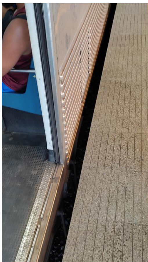
Foto 3-134: Vão inadequado entre o trem e plataforma
