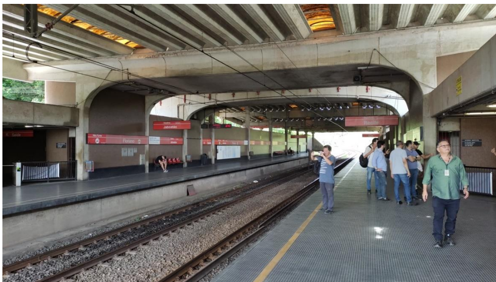
Foto 2-163: Ausência de rota tátil e elementos de acessibilidade
