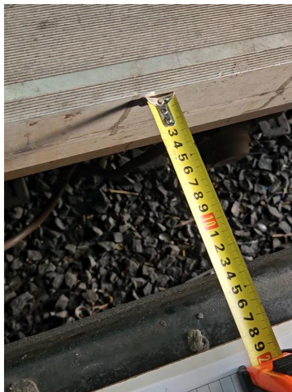
Foto 2-81: Plataforma – Vão entre trem em Plataforma sentido Jaboatão Camaragibe 14 cm, fora de Norma.
