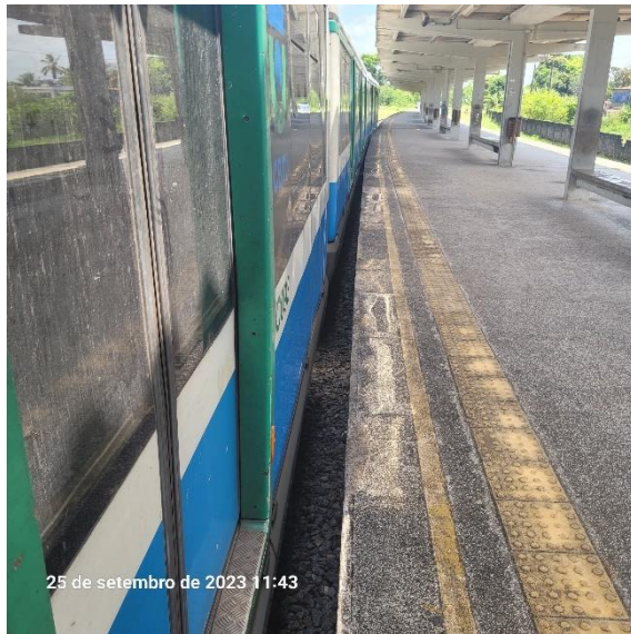
Foto 4-37: Vão excessivo entre o trem e a plataforma
