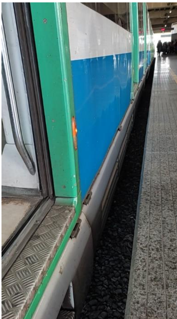
Foto 3-211: Vão excessivo entre o trem e a plataforma
