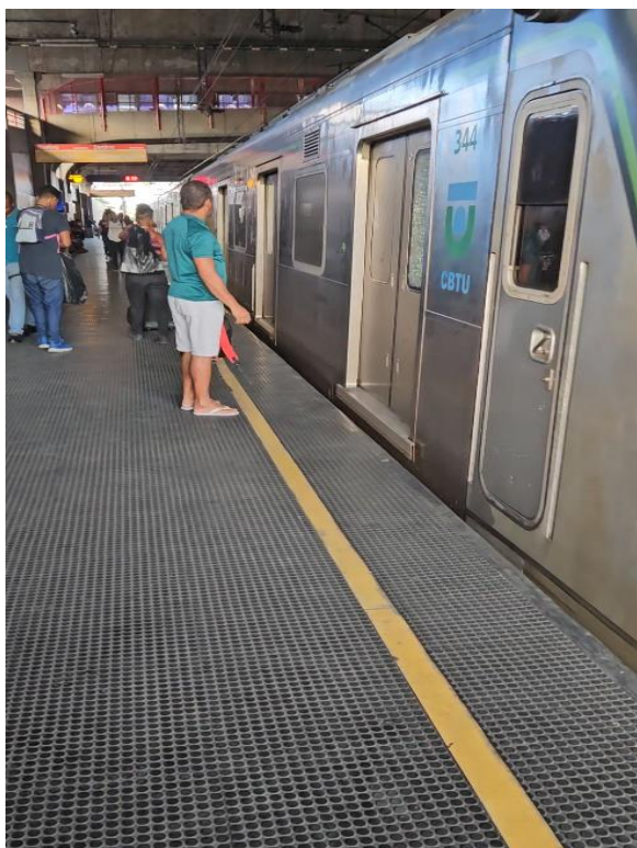
Foto 2-81: Plataforma – Vão entre trem em Plataforma sentido Jaboatão Camaragibe 14 cm, fora de Norma.
