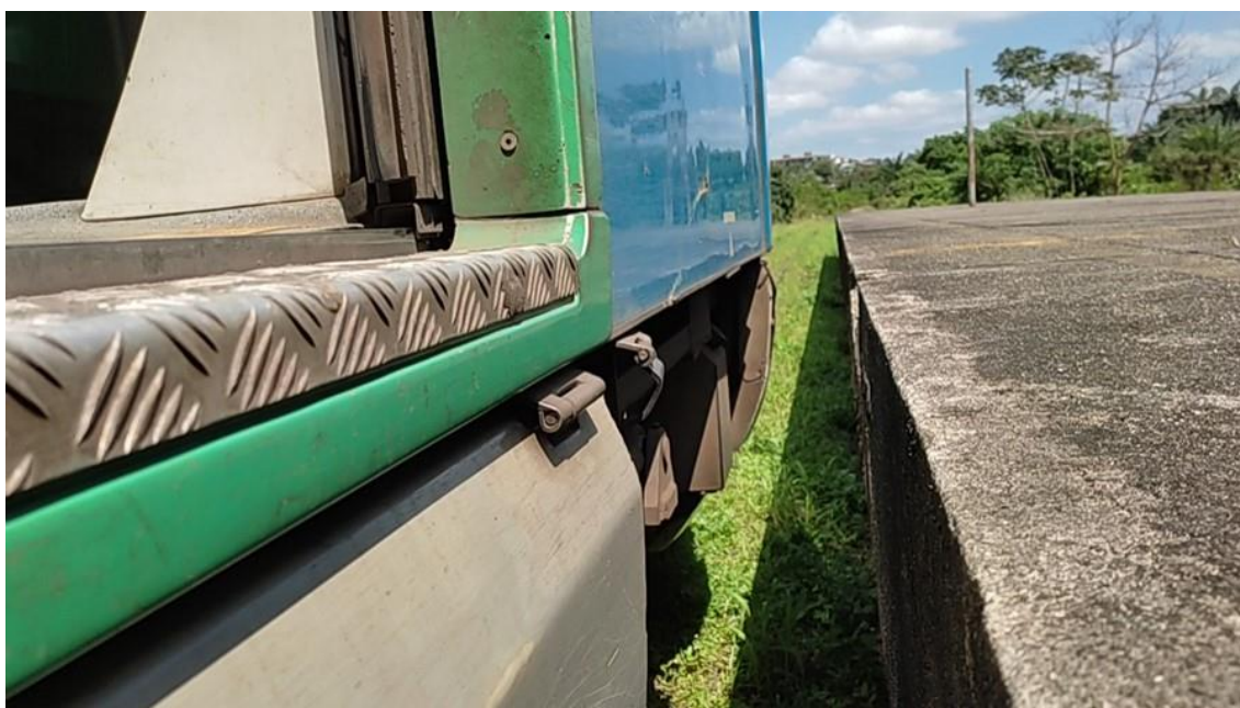
Foto 4-77: Vãos horizontal e vertical inadequados entre o trem e a plataforma
