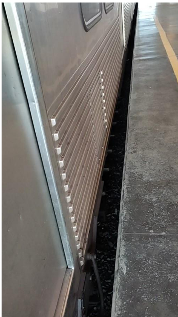
Foto 3-153: Vão horizontal inadequado entre o trem e a plataforma
