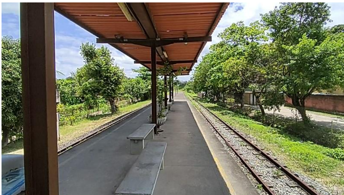
Foto 4-76: Cobertura com trechos esburcados; ausência de rota tátil
