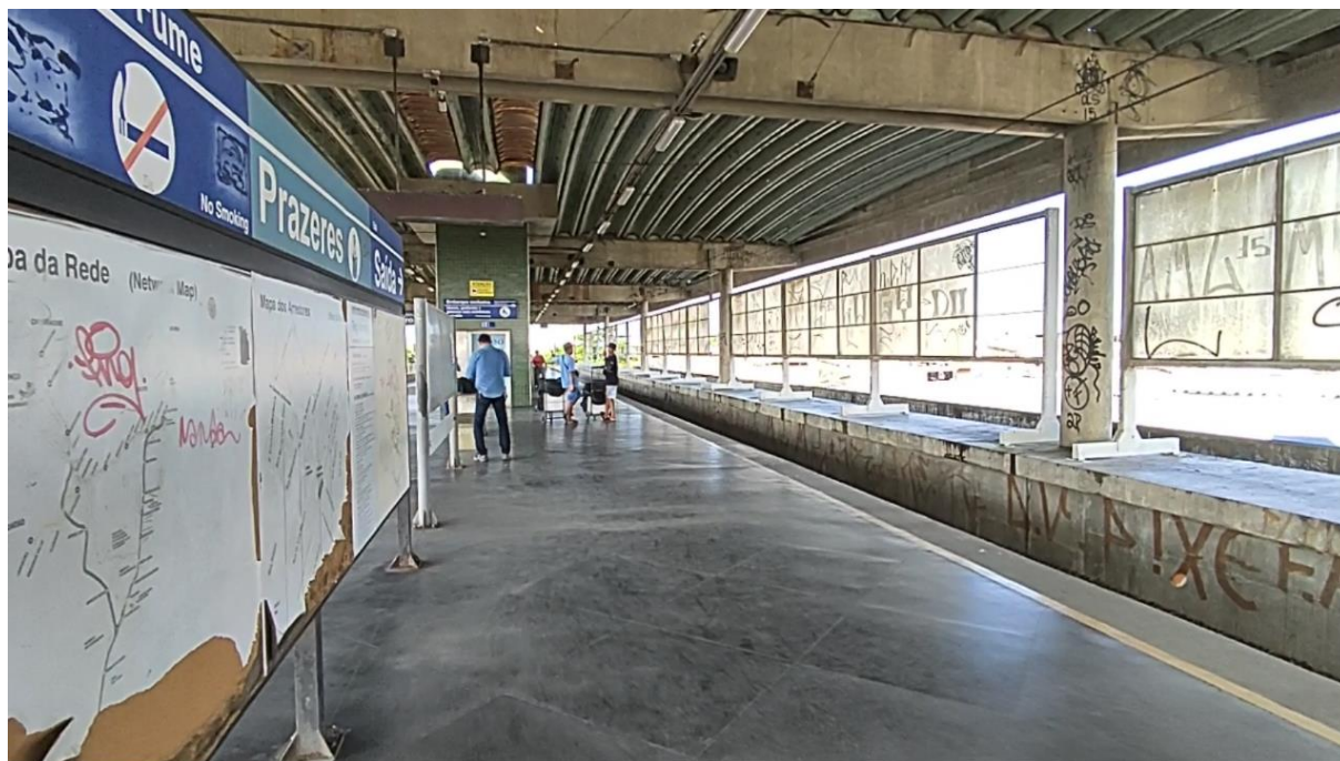
Foto 3-194: Pannel de informações danificado, ausência de piso tátil e estruturas pichadas, necessitando renovação geral
