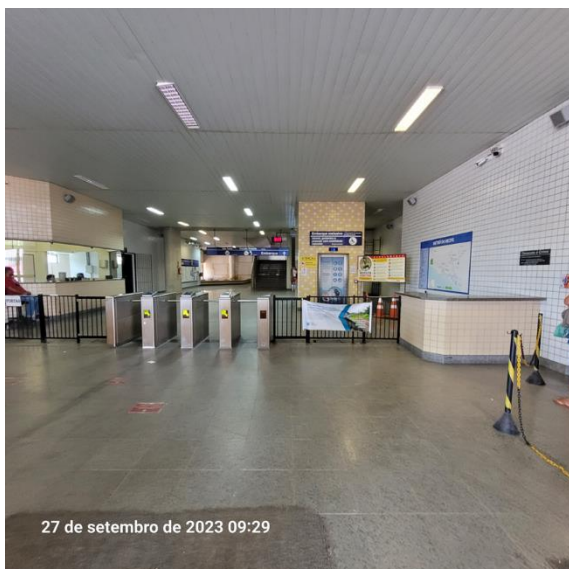
Foto 3-165: Linha de bloqueios eletrônicos, separando a área livre da área paga. À esquerda a Sala de Supervisão Operacional (SCO)
