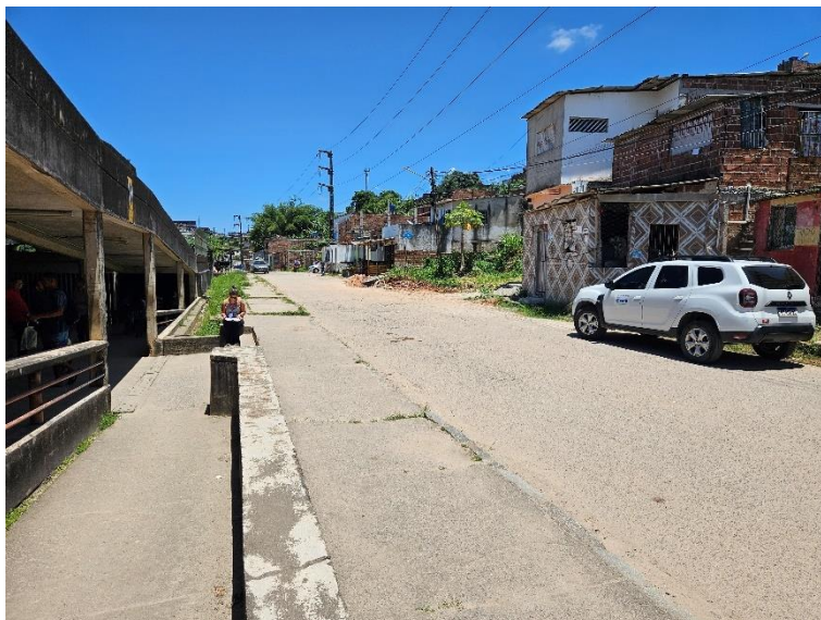
Foto 2-196: Ausência de travessia, guia rebaixada e calçada adequada
