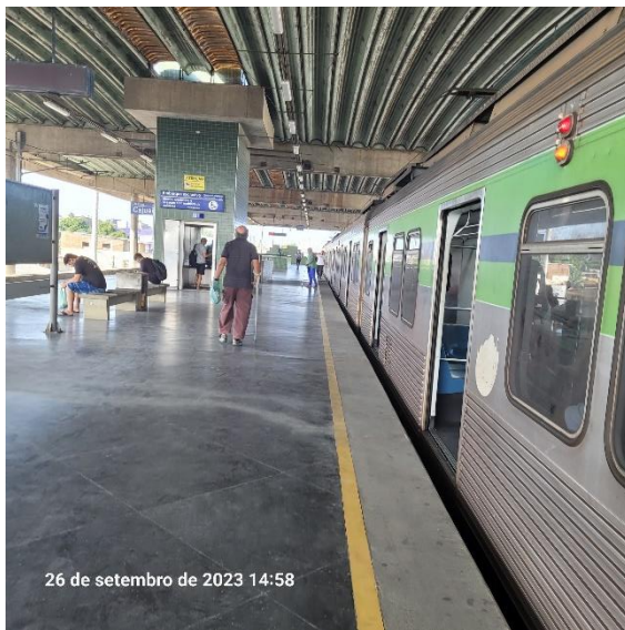
Foto 3-192: Vão excessivo entre o trem e a plataforma
