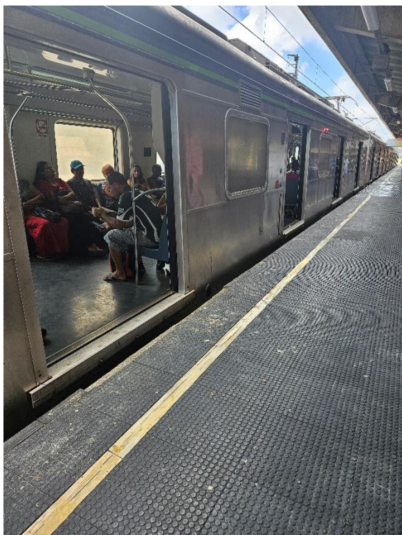
Foto 2-138: Plataformas sem rota tátil e elementos de acessibilidade
