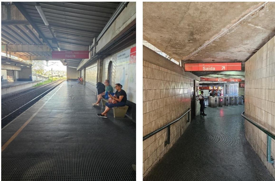
Foto 2-153: Ausência de Rota tátil e demais elementos de acessibilidade exigidos pelas Normas
