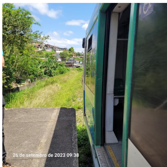
Foto 4-89: Vãos horizontal e vertical inadequados entre o trem e a plataforma
