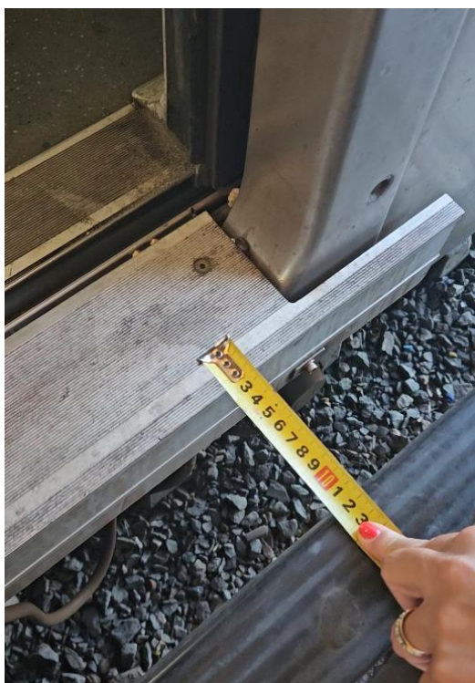
Foto 2-72: Plataforma – Vão entre trem em Plataforma sentido Recife 12 cm e sentido Jaboatão Camaragibe 13 cm, ambos fora de Norma.
